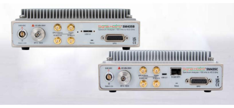
SM435系列 是一款高性能频谱分析仪和监测接收机。 频率范围为100KHz~43.5GHz,具有160MHz的瞬时带宽(IBW),110dB的动态范围,在30KHz RBW(使用 Nuttall 窗)具有1THz/s扫描速度以及超低相位噪声,可以媲美市场上最昂贵的频谱分析仪。 SM435系列的信号处理功能来自两块,一是内部的Altera FPGA,二是外部的计算机,要求处理器为i5或i7。SM435系列可用 API 轻松连接到自动监控系统或自动测试设备。
