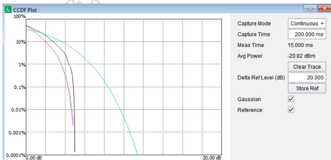
图10：将合成噪声信号与高斯参考信号和理想测试信号进行比较
